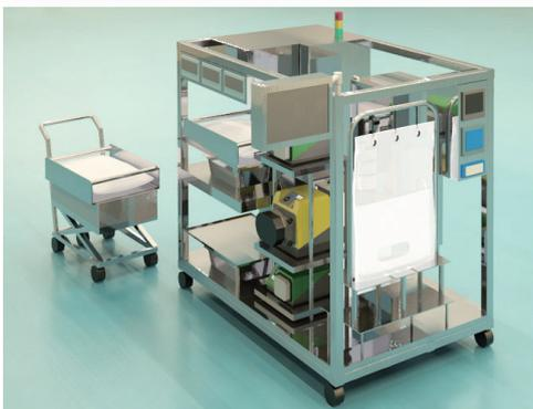
本システムはクロマト装置と連動して低 pH 処理によるウィルス不活化工程およびサンプリング操作を自動化します。クロマト溶出液は3Lからバッチ処理が可能であり、多サイクル化により抗体精製樹脂のコストダウンを実現します。バルブ形状や固定器具など随所にセットアップミスを防ぐ工夫を施しているため、オペレータのスキルに依存することなく、確実なセットアップが可能です。
